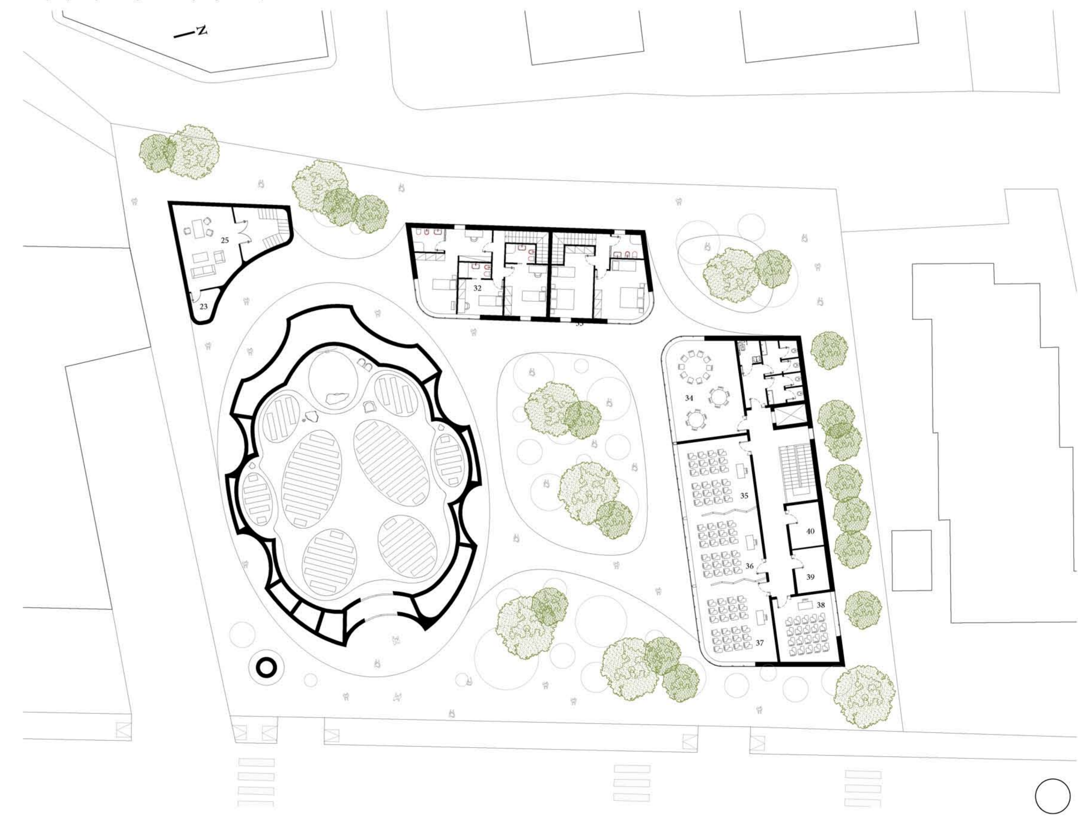
Pianta piano primo e planimetria generale del complesso parrocchiale | Scala 1:200
